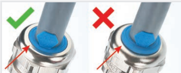
Abb. 1 – Druckschraube anziehen, bis Dichteinsatz und Druckschraube auf einer Höhe sind. Fig. 1 – Tighten pressure screw visual until pressure screw and sealing insert are at the same level.
